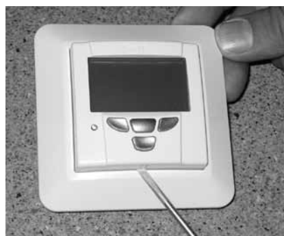
Demontering av frontplattan på en Premium kontrollpanel.
